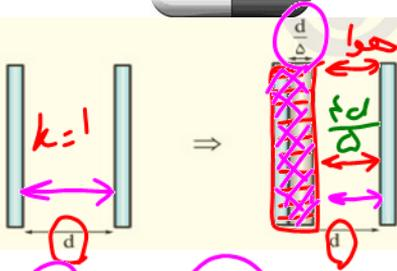
۱۸ فاصله بین دو صفحه نازک (با ضخامت ناچیز) خازن مسطحی  $d$  است و بین دو صفحه هوا وجود دارد. اگر مطابق شکل ضخامت یکی از صفحه‌ها را به اندازه  $\frac{d}{5}$  افزایش دهیم، ظرفیت خازن چند درصد و چگونه تغییر می‌کند؟
