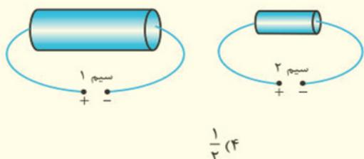
۲) در مدارهای روبه‌رو، سیم‌های (۱) و (۲) هم‌جنس هستند و هر دو به اختلاف پتانسیل یکسانی وصل شده‌اند. اگر طول و شعاع مقطع سیم (۱) دو برابر طول و شعاع مقطع سیم (۲) باشد، در هر ثانیه تعداد الکترون‌های عبوری از مقطع سیم (۱) چند برابر تعداد الکترون‌های عبوری از مقطع سیم (۲) است؟
