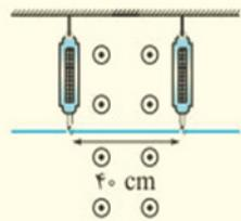
۶) در شکل یک تکه سیم به جرم  $100\text{ g}$  توسط دو نیروسنج در میدان مغناطیسی یکنواختی به بزرگی  $0.25\text{ T}$  نگه داشته شده است. جریان  $I$  را در چه جهتی و با چه اندازه‌ای بر حسب آمپر در سیم برقرار کنیم تا هر کدام از نیروسنج‌ها  $0.75\text{ N}$  را نشان دهند؟ ( $g = 10\text{ N/kg}$ )
