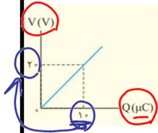
۱۹ در شکل مقابل، نمودار اختلاف پتانسیل دو سر خازنی برحسب بار ذخیره‌شده ( $V-Q$ ) در آن را مشاهده می‌کنید. اگر حداکثر ولتاژی که بتوانیم به دو سر خازن اعمال کنیم  $60V$  باشد، حداکثر انرژی ذخیره‌شده در خازن چند میکروژول است؟
