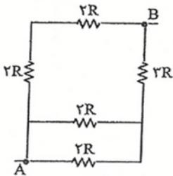
۹۶. در شکل زیر، اگر مقاومت الکتریکی بین دو نقطه A و B برابر  $3\Omega$  باشد، چند اهم است R؟
