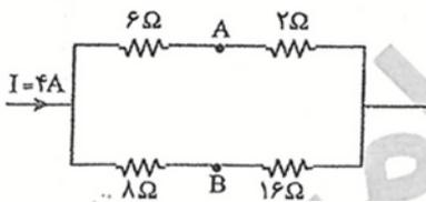
۶۷. در شکل زیر اختلاف پتانسیل دو نقطه  $A$  و  $B$  چند ولت است؟
