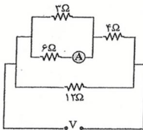
۱۰۷. در شکل روبه‌رو آمپرسنج عبور یک آمپر را نشان می دهد. ولتاژ دو سر مدار ( $V$ ) چند ولت است؟ (کنکور زیرخانی)
