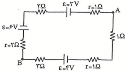
۴۹. در شکل مقابل اختلاف پتانسیل بین دو نقطه A و B ( $V_A - V_B$ ) چند ولت است؟
