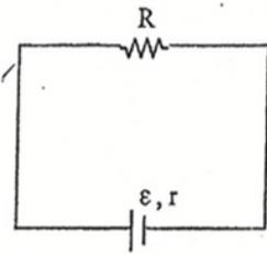
۴۸. چنانچه در مدار مقابل رابطه توان خروجی (مفید) مولد در  $SI$  به صورت  $P = 10I - 2/5I^2$  باشد، بیشینه توان خروجی مولد ..... وات و مقاومت  $R$  برابر ..... اهم است.
