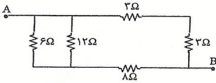
۹۵. در شکل زیر، مقاومت معادل بین دو نقطه A و B چند R است؟
