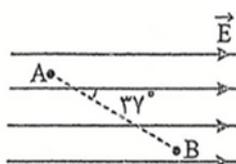
۱۱۰. مطابق شکل دو نقطه A و B، در یک میدان الکتریکی یکنواخت مشخص شده‌اند. اندازه اختلاف پتانسیل الکتریکی این دو نقطه چند ولت است؟  $\cos 37^\circ = 0.8$  و  $\sin 37^\circ = 0.6$  و  $E = 10^3 \frac{N}{C}$  و  $(AB = 1m)$  (بر گرفته از مسئله کتاب درسی)
